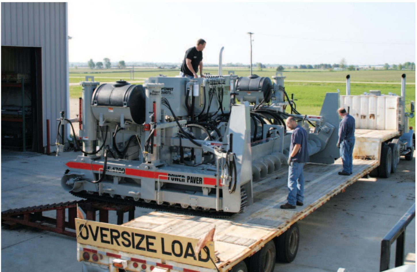
La carga y descarga de las pavimentadoras SF-1700 y SF-2700 es rápida y sencilla gracias a las rampas laterales.
