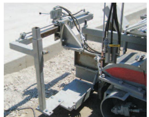
Insertador de barra lateral hidráulico opcional. También está disponible una versión manual.
