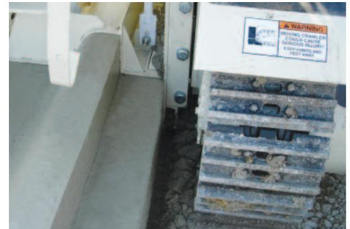
Un molde de bordillo opcional, incluso para perfiles especializados, puede agregar bordillo integral a uno o ambos lados del pavimento.
